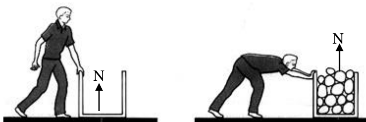
รูป 2 แรงกดในแนวตั้ง N มีค่ามากขึ้นเท่าไร แรงเสียดทานก็ยิ่งมีค่ามากขึ้นเท่านั้น
